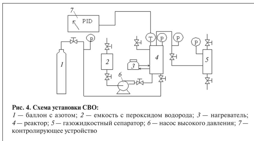
**Рис. 4. Схема установки СВО:**
