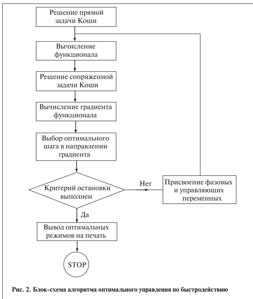
Рис. 2. Блок-схема алгоритма оптимального управления по быстродействию
