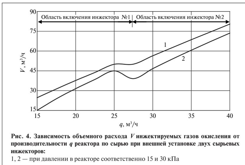
Рис. 4. Зависимость объемного расхода  $V$  инжектируемых газов окисления от производительности  $q$  реактора по сырью при внешней установке двух сырьевых инжекторов:
