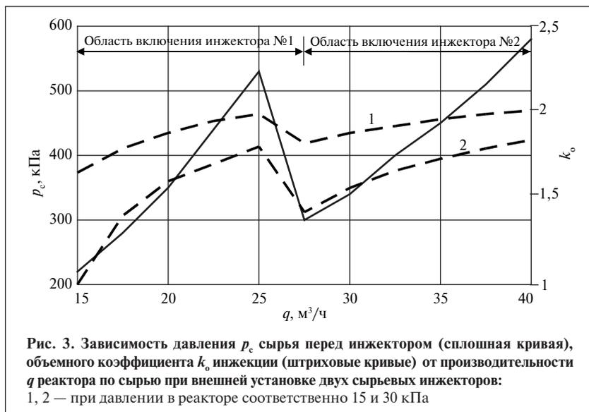
Давление сырья перед инжектором было рассчитано с учетом потери напора в линии подачи газожидкой смеси в реактор. Потеря напора из-за сложности ее расчета была принята по результатам внедрения инжекционной системы в битумном производстве ЗАО «РНПК».
