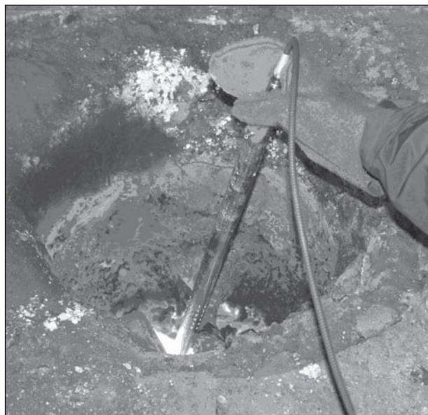
Рис. 1. Изменение температуры расплава металлов с помощью чехла
