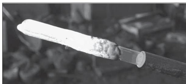
Рис. 2. Внешний вид чехла, извлеченного из расплава металла
