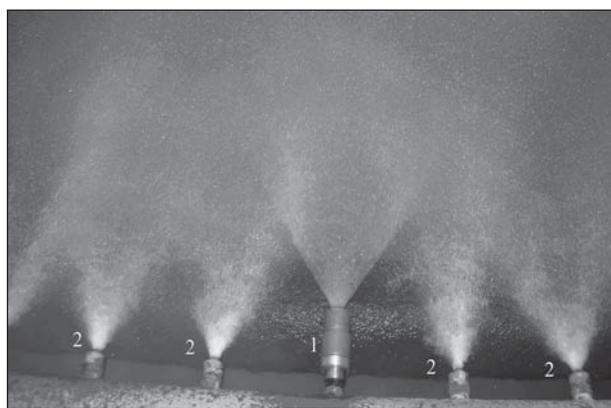
**Сравнительные испытания гидроакустических (1) и типовых форсунок (2) на градирнях блока оборотного водоснабжения**
