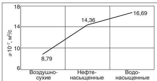
Рис. 5. Зависимость средней температуропроводности песчаников от вида насыщения
