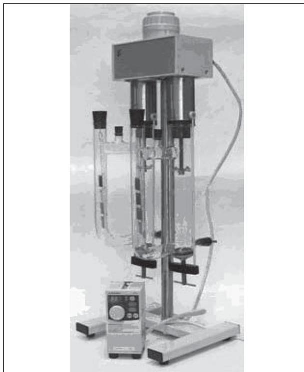
Рис. 3. Переносная лаборатория по оценке эффективности ингибиторов коррозии
