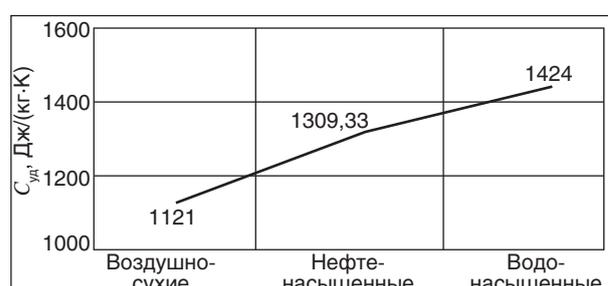
Рис. 9. Зависимость средней удельной теплоемкости песчаников от типа насыщающего их флюида
