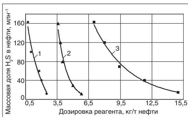
Рис. 2. Зависимость изменения массовой доли сероводорода в нефти от дозировки реагентов: 1 — 25%-ный водный раствор аммиака; 2 — 10%-ный водный раствор NaOH; 3 — 5%-ный водный раствор NaOH
