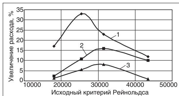
Рис. 2. Влияние интенсивности турбулентности на величину эффекта увеличения расхода в присутствии азотсодержащего ПАВ при его концентрациях, мг/л: 1 — 6; 2 — 4; 3 — 2
