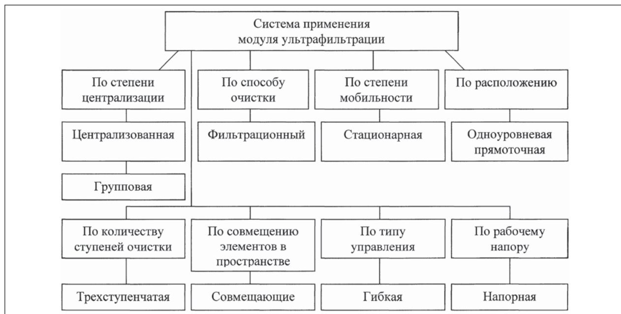
Рис. 1. Структурная схема системы применения модуля ультрафильтрации
