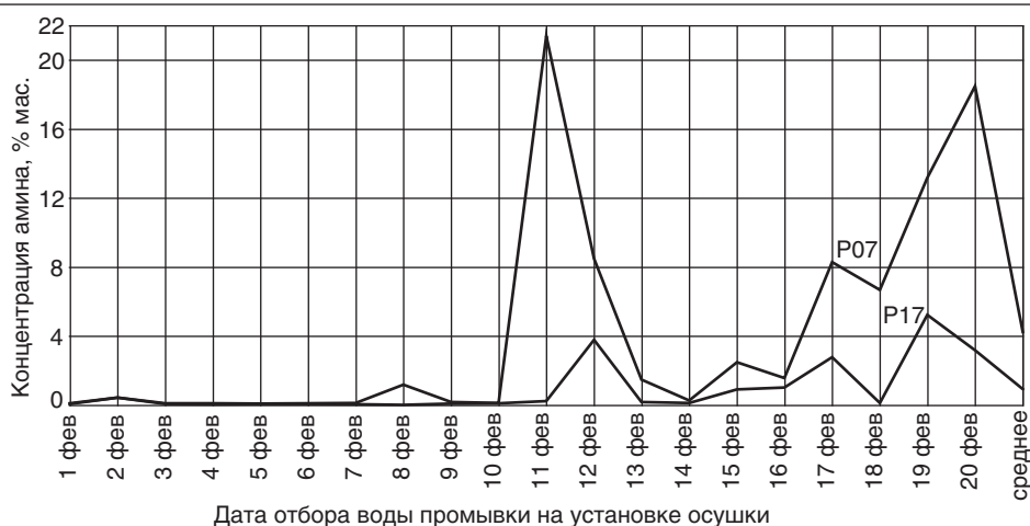
Рис. 1. Изменение концентрации амина в воде промывки газа
