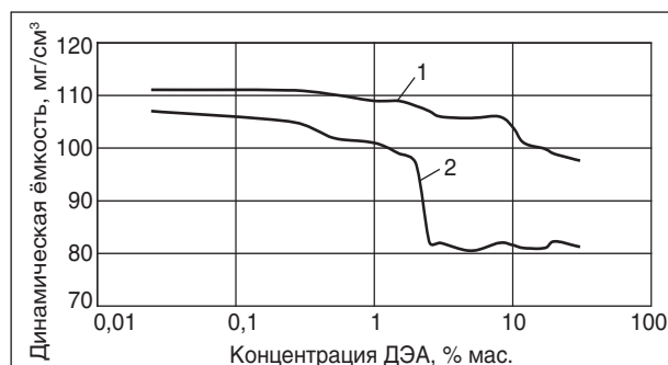
Рис. 3. Изменение динамической ёмкости образцов цеолита, обработанных растворами диэтанолamina разных концентраций при адсорбции через них воздуха (1) и смеси воздуха с диоксидом углерода (2)
